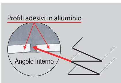
Montare i profili in modo che i due centrali distanzino fra loro di 5 mm per permettere la piegatura della stampa.
