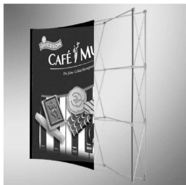
5) Dopo aver applicato la stampa sui pannelli in PVC, attaccare la barra superiore e gli angolari al retro del pannello e il nastro magnetico ai lati verticali dello stesso. Posizionare il pannello in corrispondenza delle barre magnetiche presenti nella struttura.
