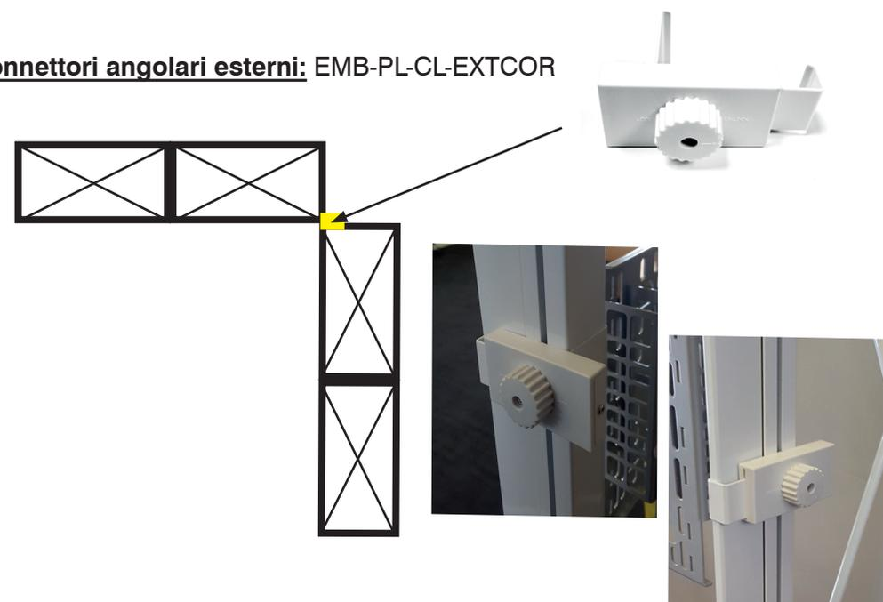
2 strutture 3X2 : 3 connettori **EMB-PL-CL-EXTCOR** (il connettore si trova all'esterno della struttura)
